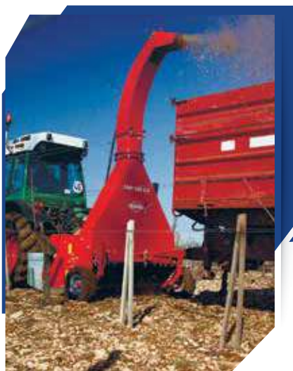
TRP175CV: для подрібнення гілок Ø до 8см та одночасним переміщенням подрібненої маси у причіп
