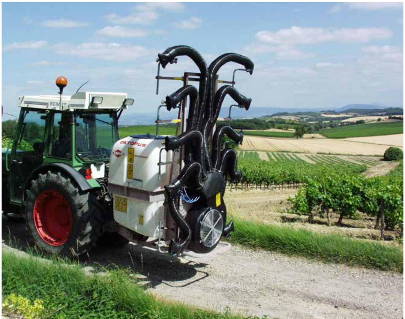
Фото 4. Обприскувач Oktopus з форсунками та повітряними рукавами
