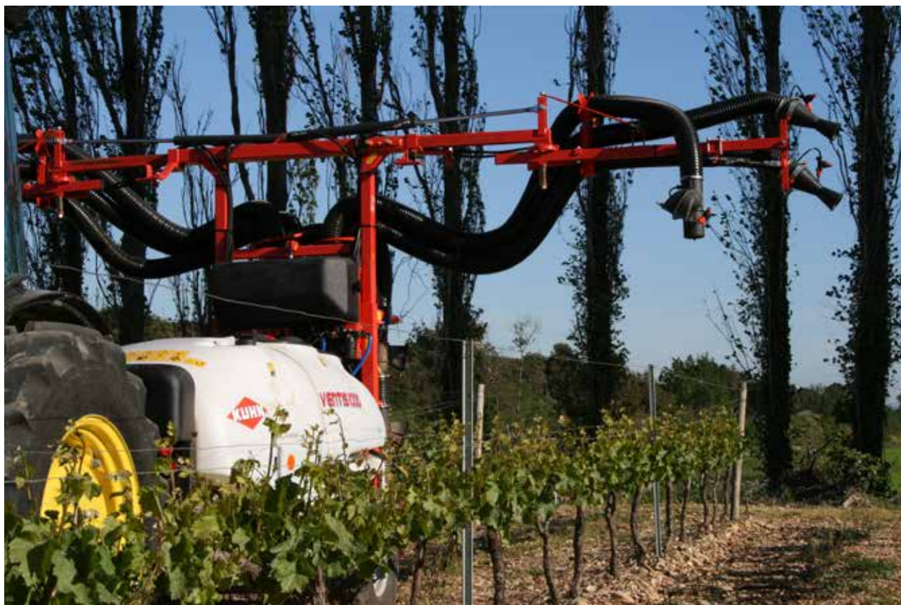
Фото 3. Обприскувач Ventis 1000 з інжекторним розпилювачем без форсунок
