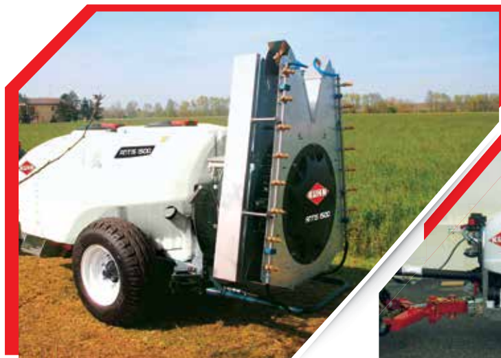
Antis V 2000: бак 2000л, обприскувач башенного типу на 14 форсунок
